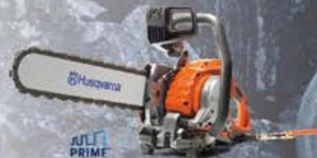
**HUSQVARNA K 6500 RING** Мощный хорошо сбалансированный электрический ручной резчик мощностью 5,5 кВт с высокочастотной технологией PRIME™ и высокой скоростью резания. Режущее кольцо диам. 425 мм обеспечивает глубину реза 325 мм.
