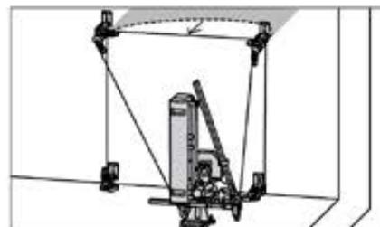
Горизонтальная резка с использованием CS 10 и внешних шкивов.
