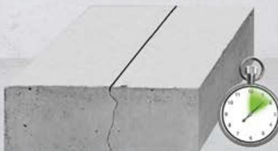
Soff-Cut работает в системе для сухой резки Ultra Early Entry™, которая уменьшает появление случайных трещин посредством создания разрезов на ранней стадии.
