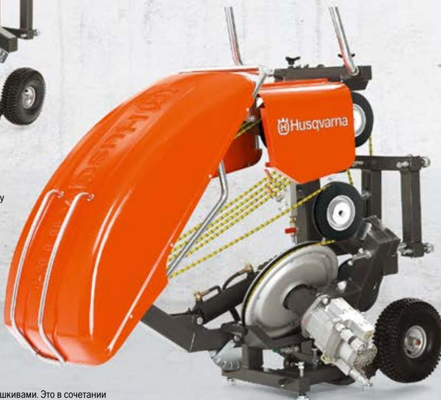
**РЕГУЛИРУЕМАЯ CS 2512** оснащается поворотными шкивами. Это в сочетании со способностью создавать вертикальные и горизонтальные разрезы обеспечивает превосходную гибкость.
