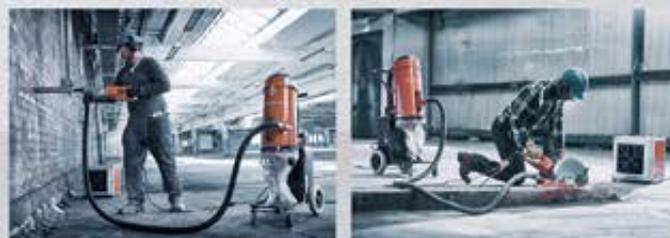
Использование интегрированного пылесборника при сухой резке или сухом бурении позволяет собирать пыль непосредственно у ее источника. Пылеуловитель с подходящими для вашего применения расходом воздуха и производительностью, оснащенный фильтрами HEPA, обеспечивает удаление пыли. Окружающий воздух фильтруется портативным очистителем воздуха 6–10 раз в час.
