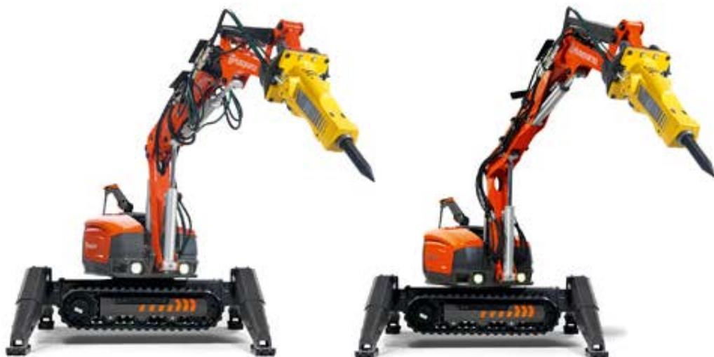
**РОБОТЫ ДЛЯ ДЕМОНТАЖА СООРУЖЕНИЙ**
