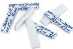
Устанавливайте элементы защиты стыков Soff-Cut на пересечениях швов, прежде чем выполнять пересекающие швы, чтобы предотвратить обламывание углов
