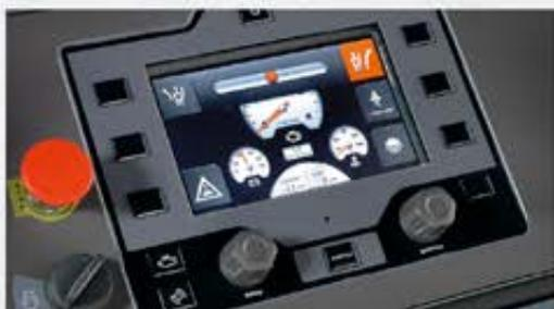
**ПРЯМЫЕ РЕЗЫ** Установленная на FS 5000 D и FS 7000 D дружелюбная к оператору панель управления содержит цифровой монитор, отображающий режим электронного слежения, что помогает создавать прямые резы, и обеспечивает высокую производительность без большой нагрузки на оператора.
