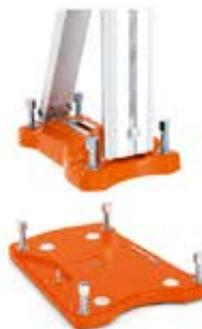
6 Плита вакуумного крепления
